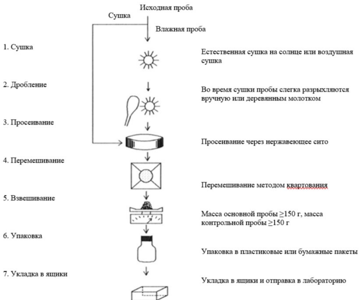
Рисунок 5-4-2 Схема технологического процесса обработки полевых проб
